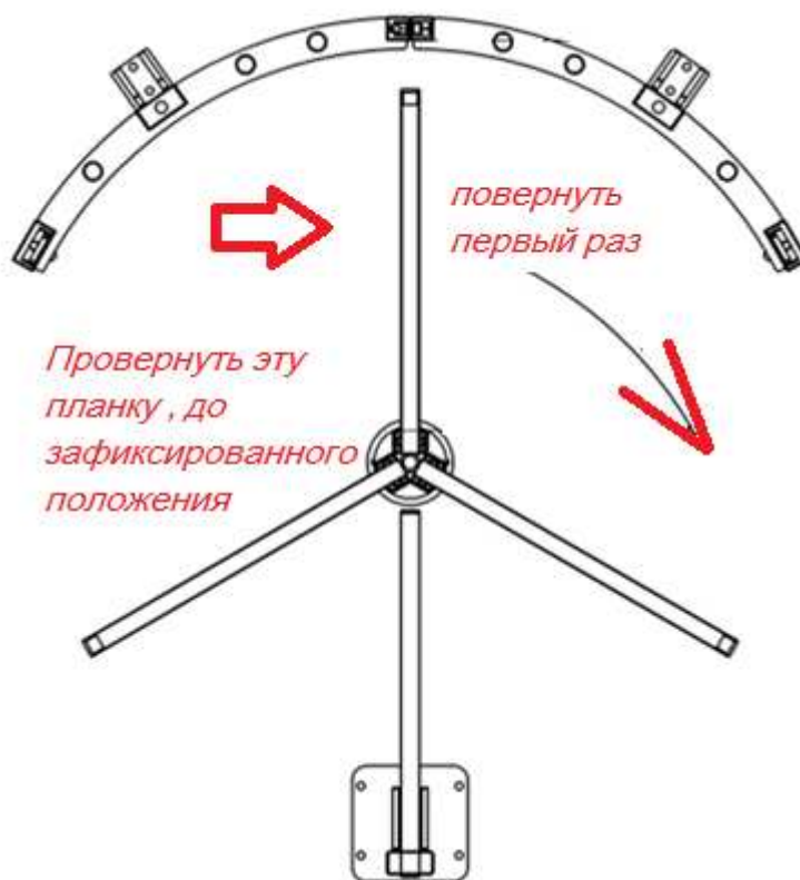
Рисунок 6 – Первый проворот ротора до следующего преграждающего положения
